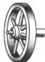
Рис. 208. Простейшее соединение колеса в оси повозки
